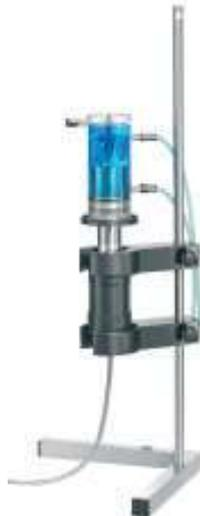
Indirekte Beschallung mit HG 40 und zusätzlicher Halterung WH 40.
